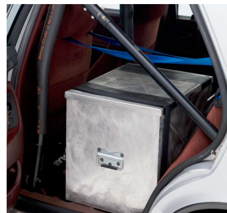
Alla reservdelar utom avgasystem och vindruta skulle rymmas i lådan. Stabbig störtbur.
