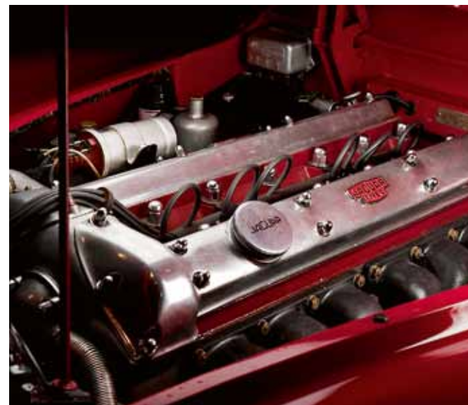
Rödlackerat topplock och små emblem på kamkåporna, det betyder C-typetrimning och 210 hästkrafter. Grenrören är emaljerade.
