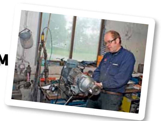
Magnus Karlsson har byggt en speciell provbänk för överväxeln – mycket praktiskt att kunna provköra lådan utan att montera den.
