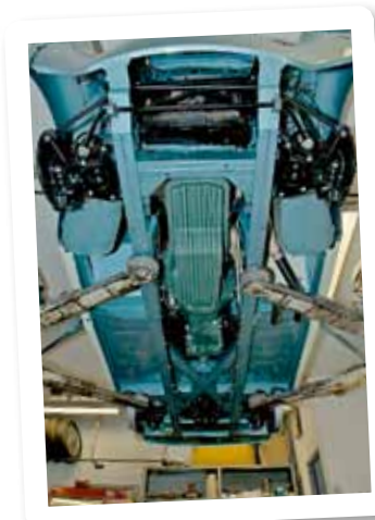
Ur detta perspektiv blir det tydligt hur långt bak motorn sitter monterad.
