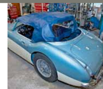
11. Maj 2010. Sufflettställningen är fortfarande på 3000 Mk I en ganska enkel sak – och tidsödande att hantera. Ändå beslutade man sig för att inte uppgradera till den senare mer användarvänliga modellen. Här provas den nya suffletten ut på originalställningen som renoverats.
