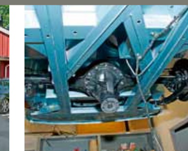
7. Oktober 2009. Det är ett nöje att montera nyrenoverade delar i ett nyrenoverat chassi. Här har bakaxeln med bladjädrar kommit på plats.
