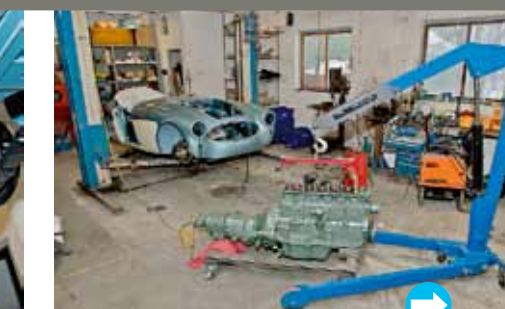
8. Januari 2010. Nu har även skärmarna och framvagnen kommit på plats. Dags för det stora lyftet. Motor och växellåda ska i samtidigt. Här gäller det att hålla tungan rätt i mun och inte skrapa i någontans.
