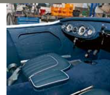
10. Maj 2010. Inredning under monterning – ett mycket mer tidsödande arbete än vad man kan tro. Alla paneler är specialbyggda för att passa just denna bil. Färdiga finns visserligen att köpa, men passar inte och har fel klädsel. Det blir läder på sätena, "leathercloth" på paneler och den bästa tillgängliga kopian av originalmattorna från Karvel.
