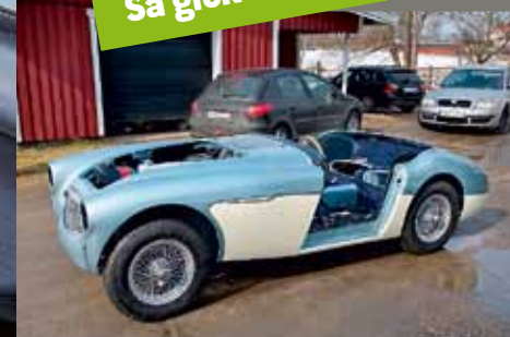
9. Mars 2010. På egna hjul igen! Magnus Karlsson tar ut bilen och rullar den en bestämd sträcka. Han räknar antalet varv som hastighetsmätarwren snurrar under denna sträcka. På det viset kan han kalibrera hastighetsmätaren, som renoveras i Schweiz.
