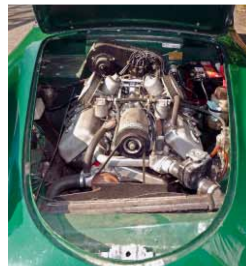
Hemitopparna fyller ut motorrummet bra. Edward Turner och Jack Wickes valde stötstänger före överliggande kammar för att hålla ner höjden så mycket som möjligt. Ändå fick huvu en rejäl bula för att svälja det hela.
